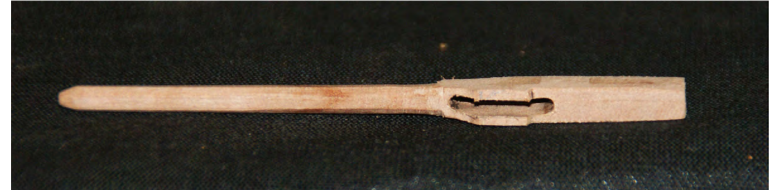
Foto n° 64 - Le guance sono state realizzate. Ora si può tagliare la parte eccedente e poi terminare la pompa.
